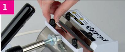
Bevor Sie den Aufsatz wechseln, trennen Sie die iXpress Transferpresse vom Strom und trennen das Kabel der Tassenpresse von der Transferpresse.
