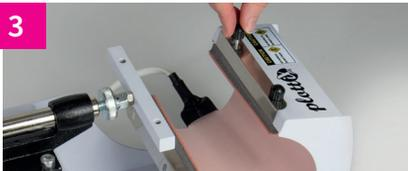
**Tipp:** Achten Sie beim Einsetzen eines neuen Aufsatzes darauf, diesen zuerst mit beiden Schrauben auf der linken Seite zu montieren.
