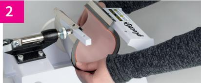
Ziehen Sie den Hebel nach hinten, um die Presse zu öffnen und entfernen Sie den Aufsatz aus dem Metallgestell.
